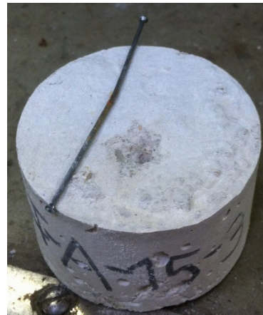
4.8.ábra: Kihúzódsott gombostűfejű acélszálak
