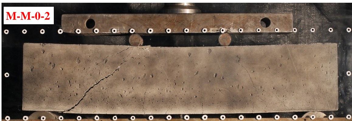
NYÍRÁSI – HAJLÍTÁSI TÖNKREMETEL (hajlítási repedések megjelenésével)
