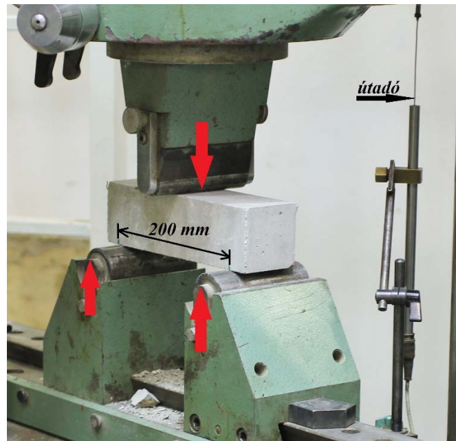
3.7. ábra: A betonhasábok hajlító-húzószilárdság vizsgálatának kísérleti összeállítása
