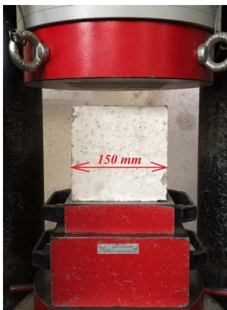
3.6. ábra: A betonkockák nyomószilárdság vizsgálatának kísérleti összeállítása
