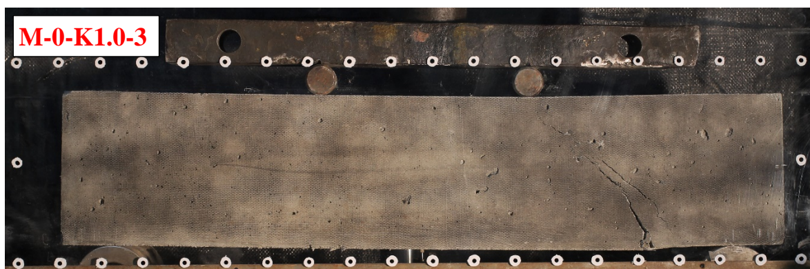
NYÍRÁSI – HAJLÍTÁSI TÖNKREMENETEL
