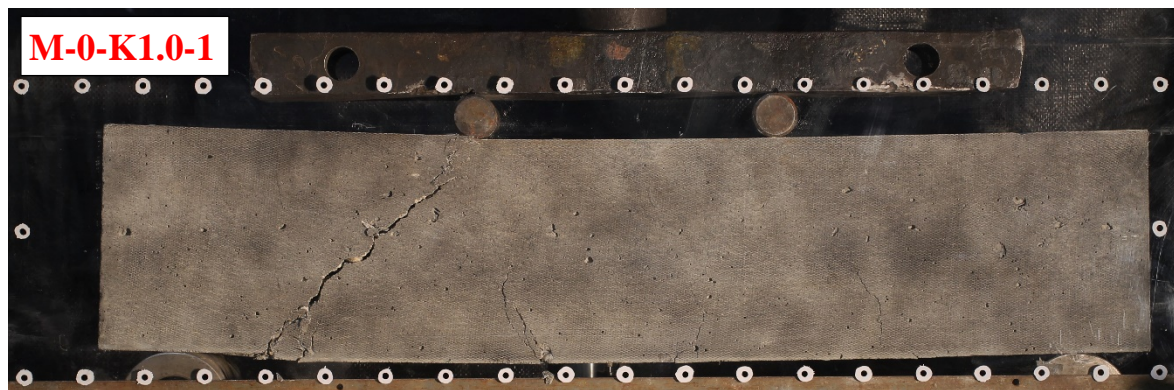
NYÍRÁSI – HAJLÍTÁSI TÖNKREMENETEL (hajlítási repedések megjelenésével)
