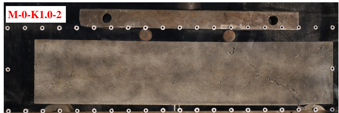
NYÍRÁSI – HAJLÍTÁSI TÖNKREMENETEL
