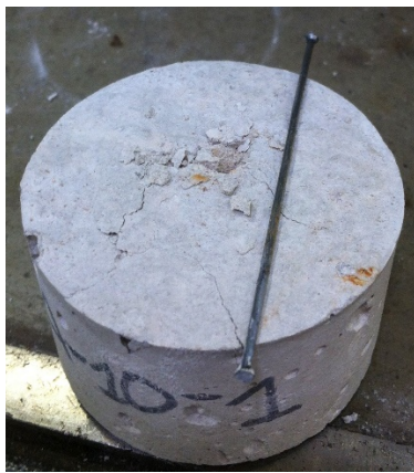
4.8.ábra: Kihúzódsott gombostűfejű acélszálak
