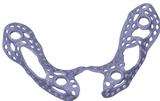
6. ábra. Tervezett titán implantátum (subperiostealis implantátum) STL fájlja
