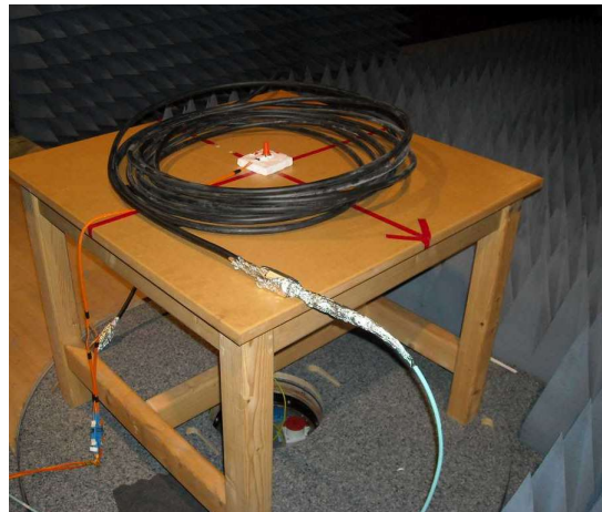
20. ábra Mérési elrendezés a kábelek árnyékolás hatékonyságának méréséhez [70]
