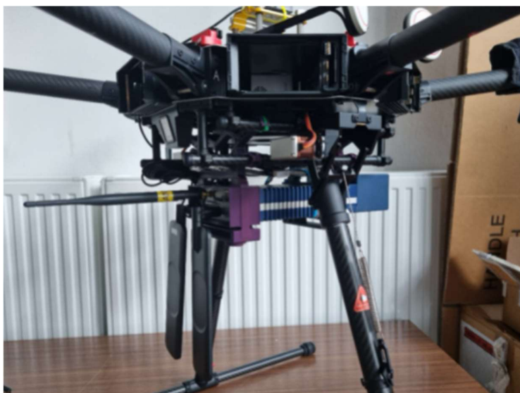
47. ábra UAV alapú Drive-test test-setup egyedi felfogató szerkezettel
