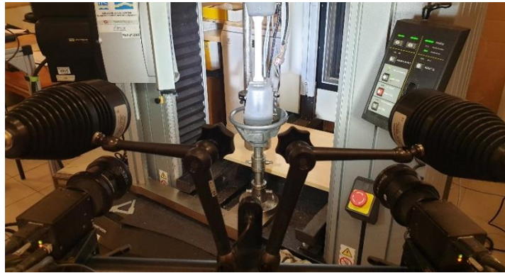
3.2. ábra. GOM Aramis 5M az Instron szakítógéppel
