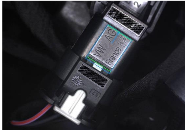
40. ábra: A műanyag címke felső széle és a csatlakozózár közötti távolság mérése
